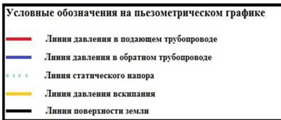
Рисунок 1.68 – Условные обозначения на пьезометрическом графике
