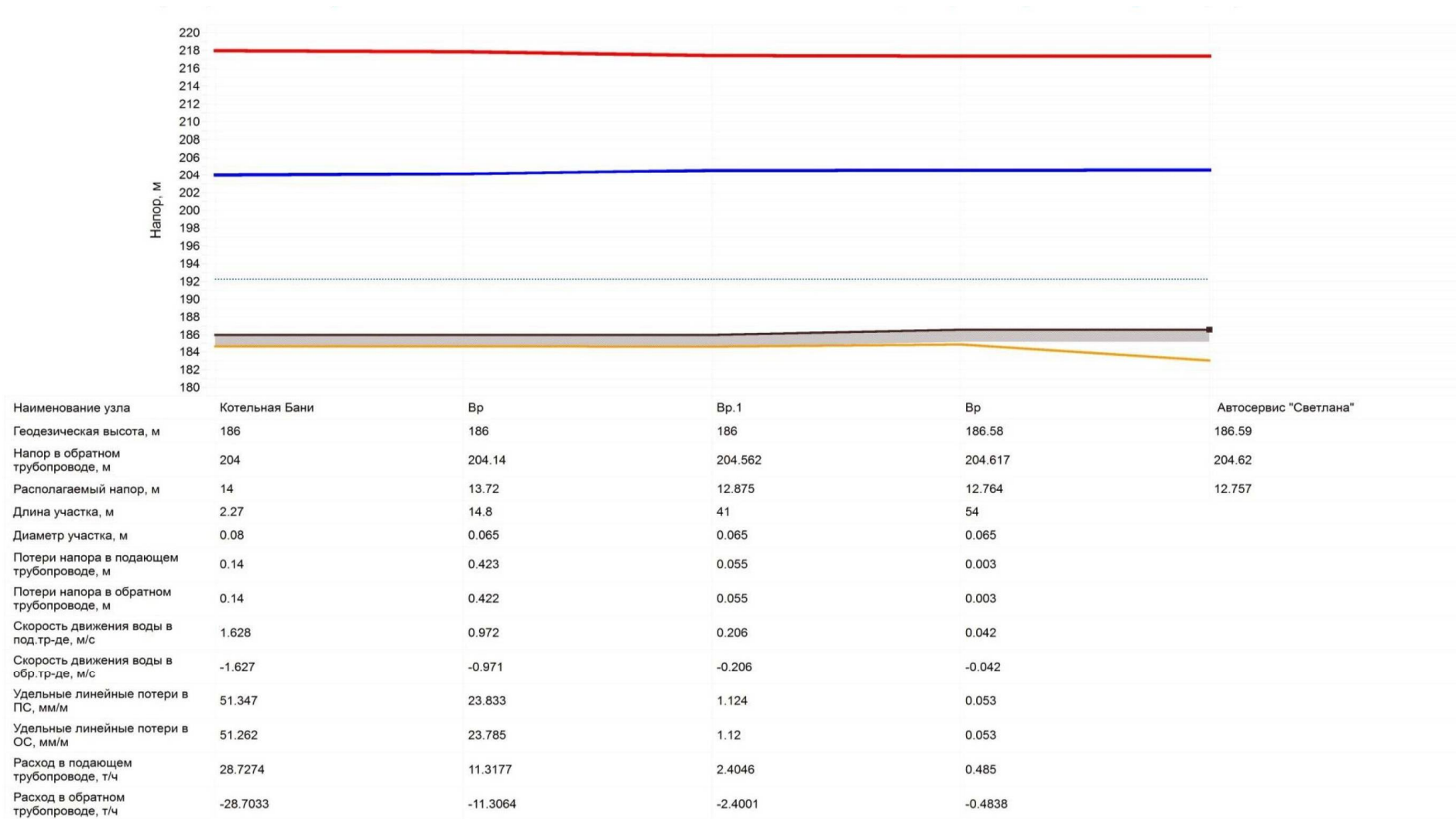
Рисунок 1.69 – Пьезометрический график вдоль расчетного пути «котельная Городской бани – автосервис «Светлана»
